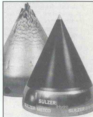
Agujas de inyector de una Pelton después de 12,000 horas útiles en la misma turbina: A la izquierda aparece sin recubrimiento cerámico y a la derecha con él.
