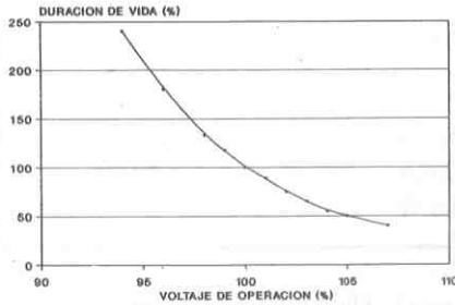
Fig. 3. Influencia del voltaje en la vida útil de las bombillas.
